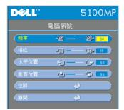
**頻率** — 改變時鐘頻率的顯示值以符合您電腦 圖形介面卡的頻率。如果出現垂直閃爍條 紋,請使用頻率控制將條紋最少化。這只能 **粗略地調整。**
